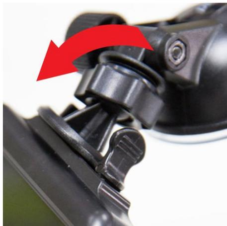
5. Quando la DrivePro™ è nella sua migliore posizione, ruotare la manopola in senso orario per assicurarsi che la DrivePro™ sia bloccata saldamente.
