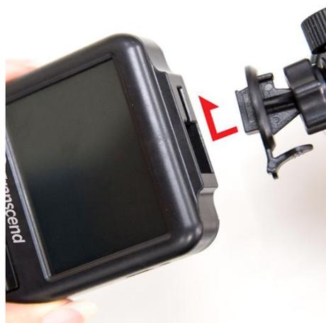
2. Pulire ed asciugare completamente la zona del parabrezza sulla quale si desidera montare la DrivePro™. Se possibile, fissare la DrivePro™ nel mezzo del parabrezza vicino allo specchietto retrovisore per un migliore campo visivo.
